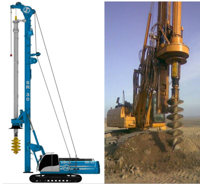
شکل ۳-۲ یک نمونه دستگاه حفار روتاری (دورانی) شمع.
