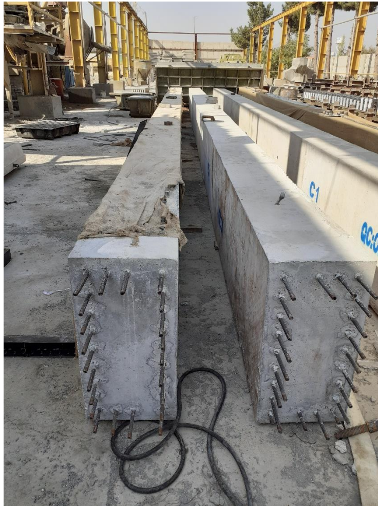
شکل ۳-۳ ستون‌های پیش‌ساخته بتنی آماده شده در کارخانه برای حمل به محل پروژه
