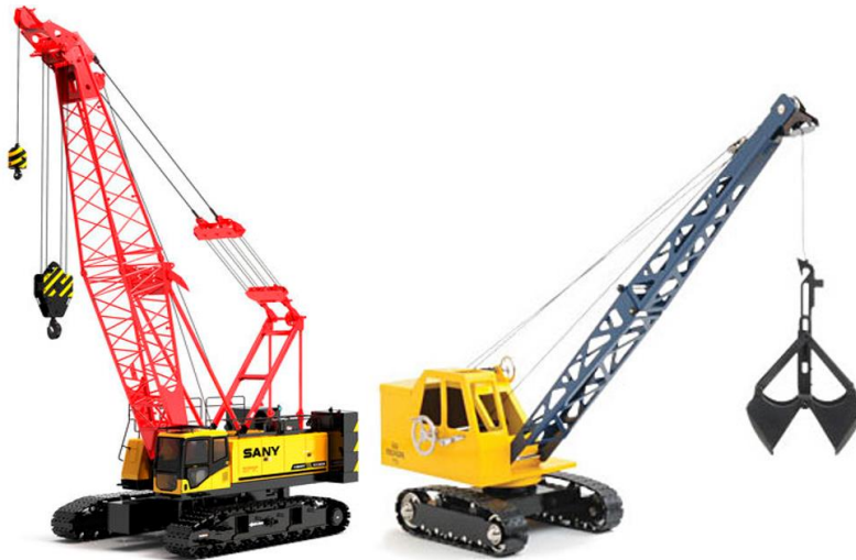
شکل ۳-۸۰ تصویر شماتیک از جرثقیل بوم خشک که می‌توان یک چنگک را جهت تخلیه خاک به آن آویزان نمود
