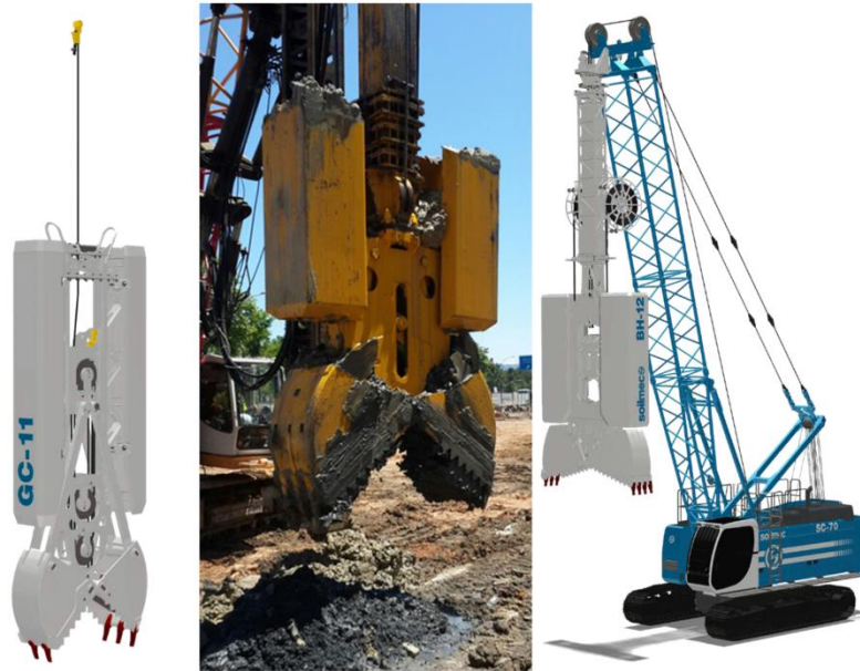
شکل ۳-۳ اجزاء حفاری چنگک که از یک دستگاه جرثقیل معلق است.
